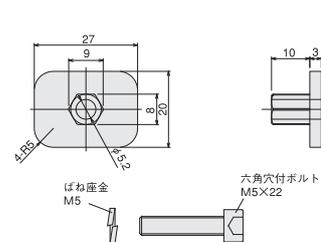
・パワーモータ取付軸の固定は3.0Nm、金具の固定は3.5Nmで締めつけてください。
